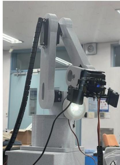
파악한 현재 하노이탑의 상태를 바탕으로, 추후 동작 및 순서 결정 결정한 동작에 맞는 로봇 팔 좌표 이동 및 그리퍼 제어
